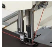
自動車シート縫製等にCS(カーシート)仕様をラインナップ。天秤ストローク、送りモーションを変更し、シート縫製品質が一段と向上しました。
