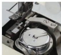
送り歯と平行に直線運動する移動メスと固定メスの噛み合い方式により、優れた切れ味で細糸から太糸(#8)まで鋭く切断します。
